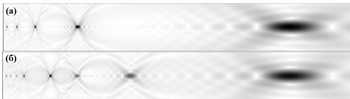
Рисунок – Продольное распространение бинарного оптического пучка с уровнем бинаризации (а) 0.5 и (б) 0.4
