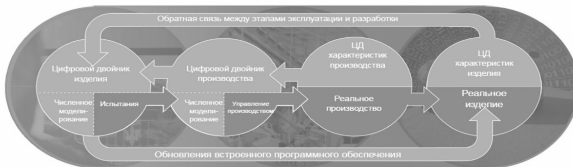
Рис. Процесс производства с использованием цифрового двойника (ЦД)
