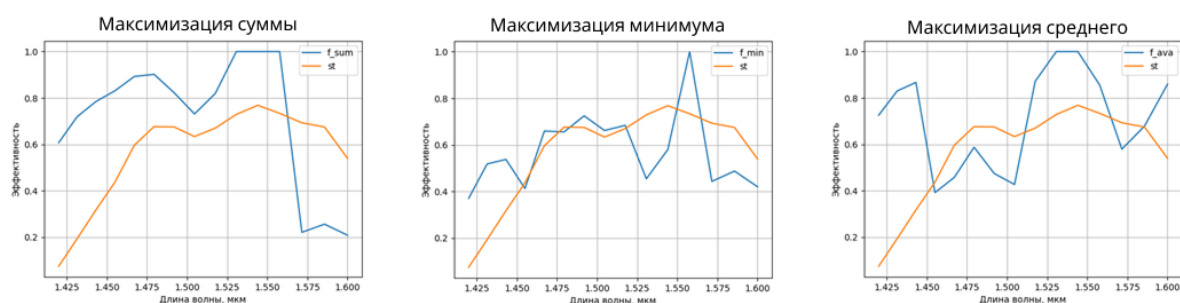
Рисунок 2 – Сравнение эффективностей исходного узла пересечения с результатами оптимизации: оранжевая линия – изначальное пересечение, синяя – результат оптимизации
