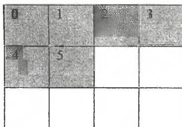
Рис. 6.1 Последовательность обхода отсчетов изображения при построчной развертке
