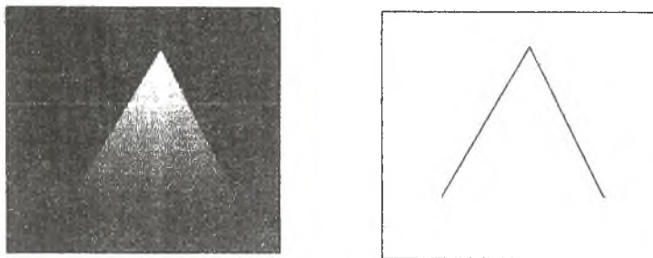
Рис. 2.3 Разрыв контурной линии на участке с плавно меняющейся яркостью
