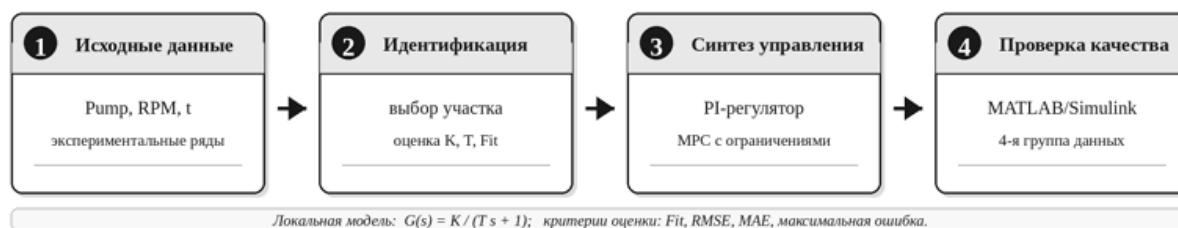
Рис. 1 – Структурная схема обработки экспериментальных данных и синтеза регулятора
