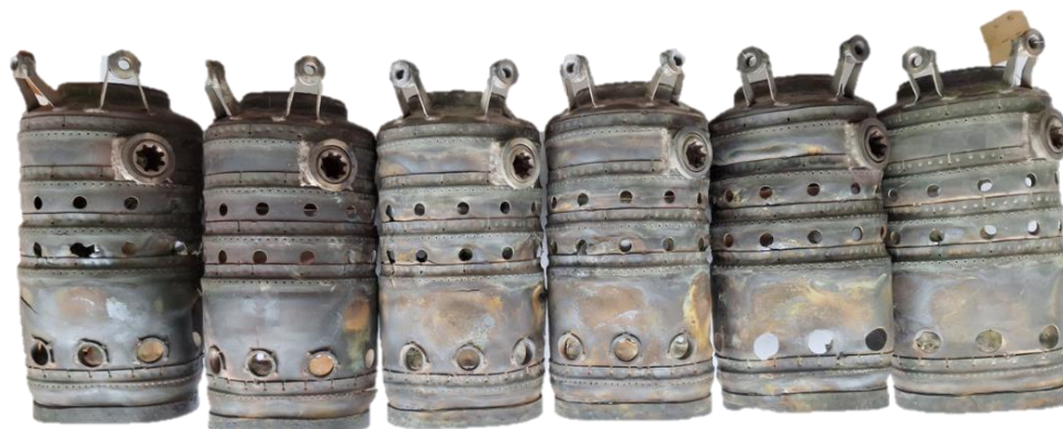
Рис. 1 – Трубы жаровые после наработки
