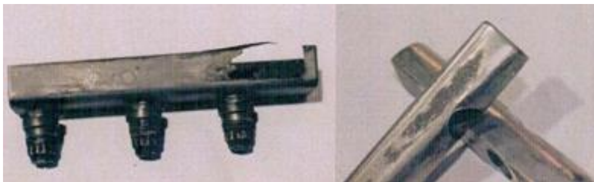
Рис. 2 – Износ вставки и ползуна регулируемого сопла соответственно
