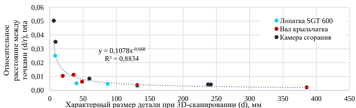
Рис. 2 – Оценка соответствия заданного расстояния между точек характерному диаметру детали
