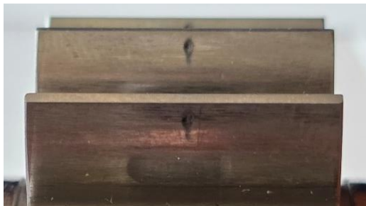
Рис. 1 – Прожиг на вершине зуба
