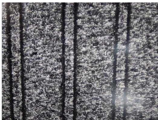
Рис. 2 – Шероховатая пластина с интенсификаторами при 50-кратном увеличении
