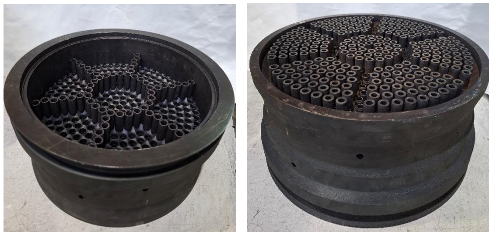
Рис. 1 – Опытный образец смесительной головки камеры, изготовленный при помощи аддитивных технологий
