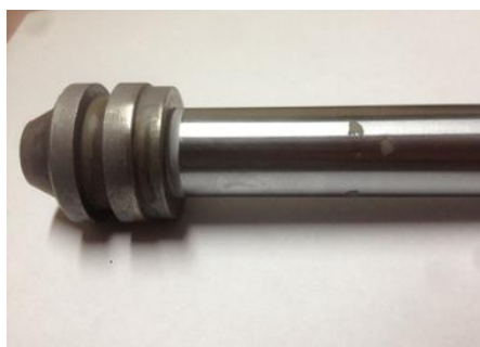
Рис. 1. Шток из материала ВТЗ-1 с дефектами хромового покрытия
