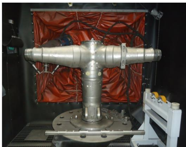
Рис. 1. Упрочняющая обработка траверсы на роботизированной установке
