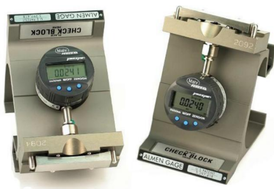
Рис. 1. Современные приборы TSP-3 для измерения интенсивности упрочняющей обработки согласно стандарту SAE J442
