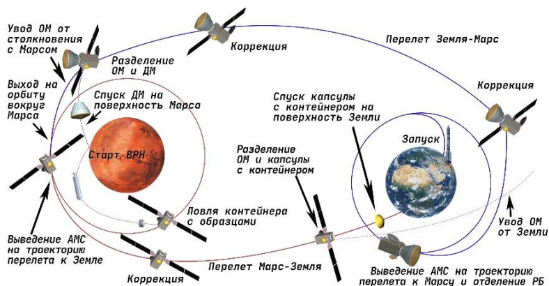
Рис. 2. Баллистическая схема перелёта Земля–Мартс–Земля
