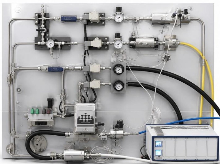
Рисунок 5.6. Панель управления расходами и схема двухконтурной подачи природного газа и водорода
