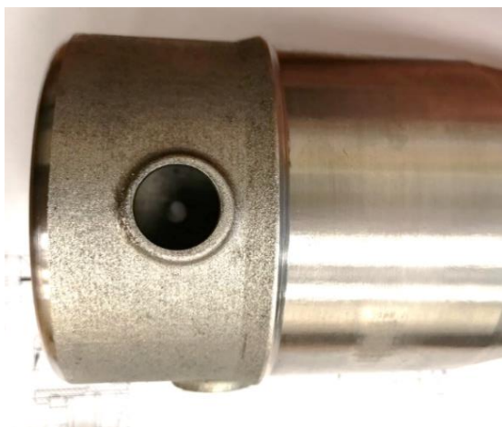
Рисунок 5.14. Жаровая труба, изготовленная методом селективного лазерного сплавления после механической обработки
