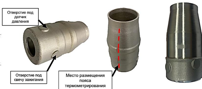
Рисунок 5.4. Пример реализации технологичной конструкции жаровой трубы и корпуса камеры для экспериментальных исследований
