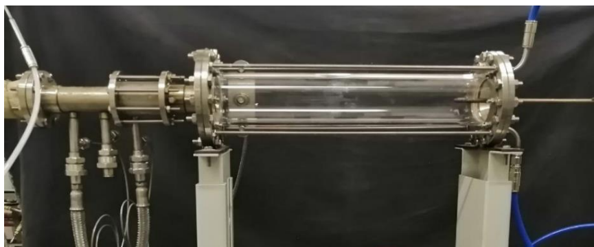
Рисунок 5.17. Модельная камера сгорания с установленной кварцевой трубой и смонтированными измерительными системами
