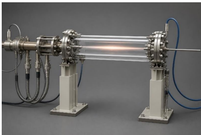
Рисунок 5.12. Пример модельной камеры сгорания с кварцевой жаровой трубой для визуального наблюдения факела
