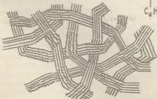
Рис.3. Модель структуры линейного полимера.
