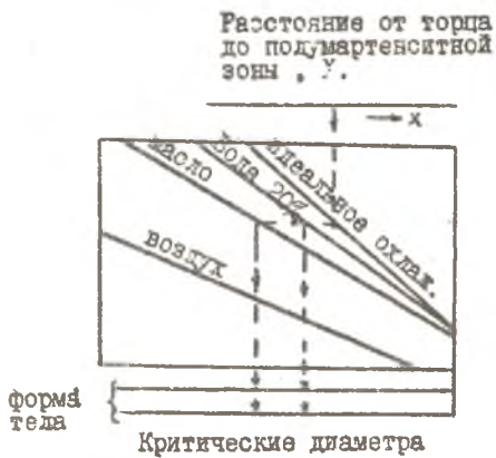
Рис. 3. Схема расчёта прокаливаемости по номограмме Блятера.
