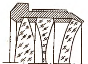
Р и с. 6.2. Крепление оптических деталей за- вальцовкой
