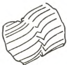
Р и с. 5.3. Трубка с продольными ребрами
