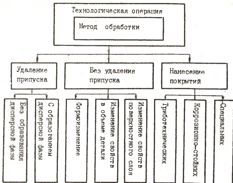
Р и с. 2.2. Классификация методов обработки по технологическому назначению выполняемых операций
