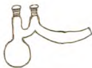
Рис. 8 а. Перегонная колба с саблевидным холодильником
