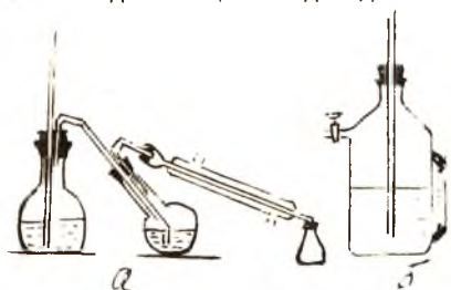
Рис. 6 /а и б/. Прибор для перегонки с водяным паром
