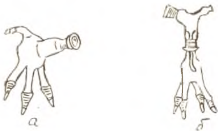
Рис. II. Модификации алонжей: а/ "паук" трехрожковый; б/ "паук" четырехрожковый.
