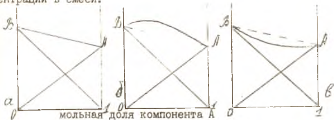
Рис. 4. Упругость паров бинарных смесей: идеального раствора /а/, раствора со значительным положительным /б/ и со значительным отрицательным /в/ отклонением от закона Рауля.
