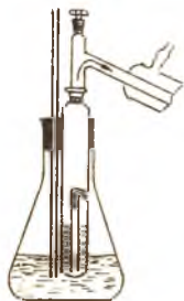
Рис. 7. Прибор для перегонки небольших количеств вещества с водяным паром
