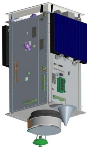
Рисунок 2.18 – Внешний облик МКА ДЗЗ на базе УП «АИСТ-2» с целевой аппаратурой сверхвысокого разрешения
