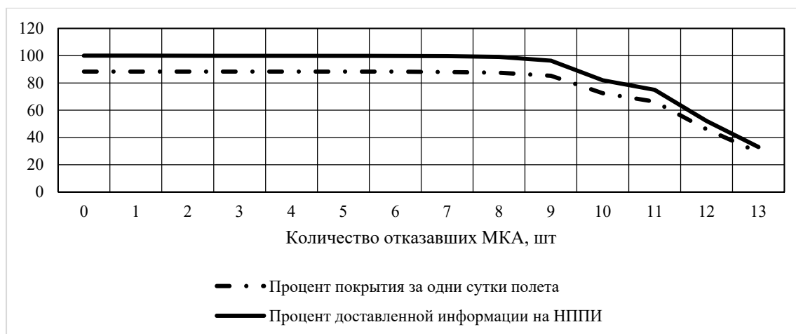
Рисунок 2.25 – Процент покрытия поверхности Земли за одни сутки полёта и процент доставленной информации ДЗЗ на НППИ
