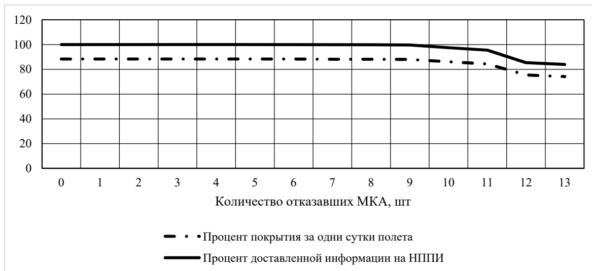
Рисунок 2.28 – Изменение процента покрытия поверхности Земли за одни сутки полёта и процент доставленной информации ДЗЗ на НППИ
