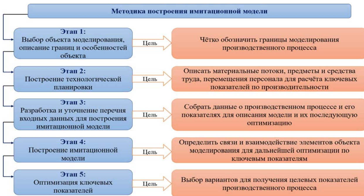
Рисунок 3.7 – Методика построения имитационной модели производственного процесса
