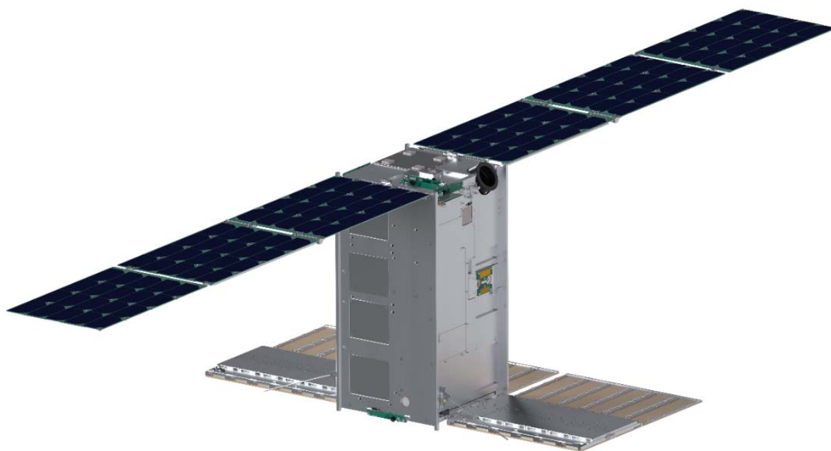
Рисунок 2.21 – Проектный облик МКА ДЗЗ «АИСТ-СТ» с радиолокационной аппаратурой наблюдения на базе УП 16-юнитового кубсата
