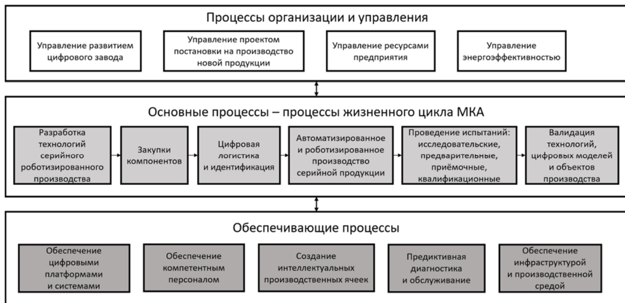
Рисунок 3.19 – Процессная модель «цифрового завода» по серийному производству МКА
