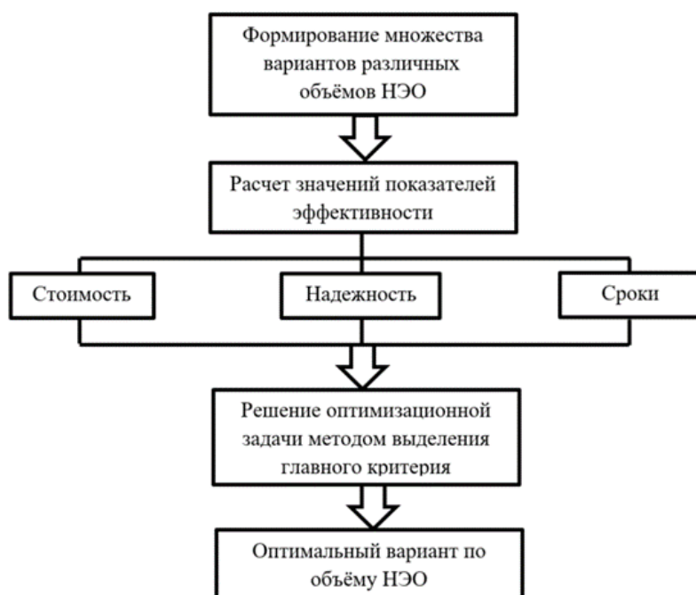
Рисунок 3.25 – Обобщённая схема оптимизации объёмов НЭО КА
