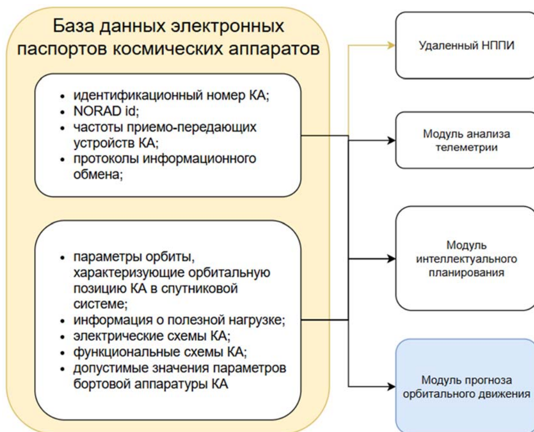
Рисунок 4.2 – Схема информационных связей базы данных электронных паспортов космических аппаратов
