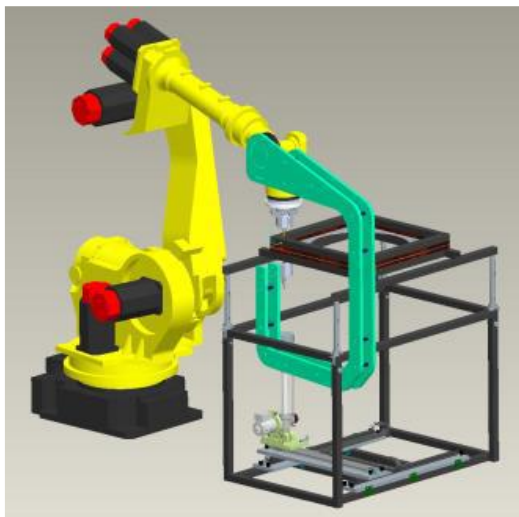
Рис. 7. Пример применения С-образной рамы на роботe-манипуляторе [21]
