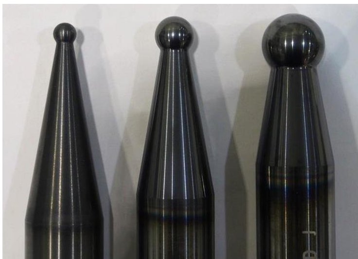
Рис. 12. Инструмент с шарикообразным наконечником (диаметр 6 мм, 10 мм и 16 мм)
