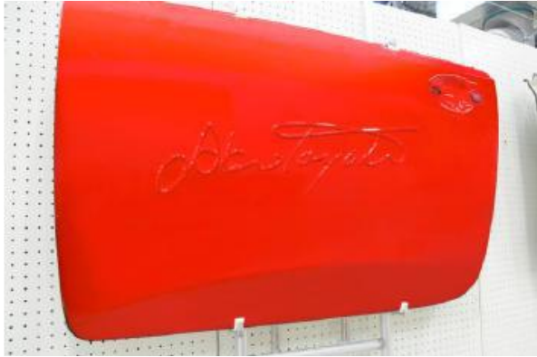
Рис. 19. Дверь автомобиля Toyota, изготовленная методом ИФ [12]
