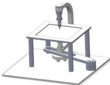
Рис. 8. Варианты механизмов для небольших размеров обрабатываемой поверхности (начало рис. на стр. 13): (в) с механизмом ротационного и поступательного стабилизатора
