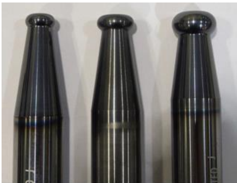
Рис. 13. Инструмент с плоским наконечником (диаметр 6 мм, 10 мм и 16 мм)
