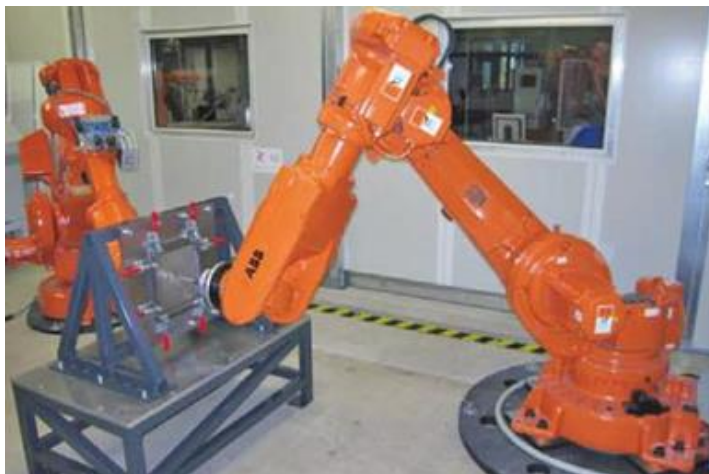
Рис. 4. Двухстороннее инкрементальное формование с помощью синхронизированных роботов АВВ [13]
