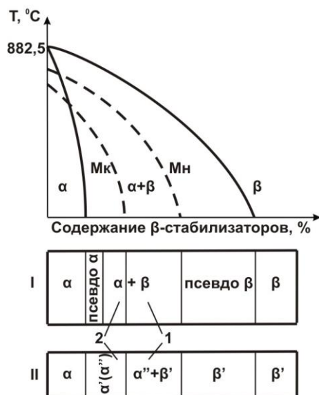
Рис. 22. Структуры титановых сплавов переходного (1) и мартенситного (2) класса в отожженном (I) и закаленном (II) состояниях [2]
