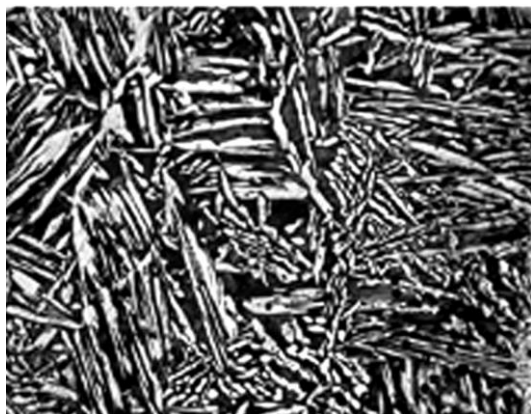
Рис. 6. Литая латунь ( \alpha+\beta ), \times 100 [2]
