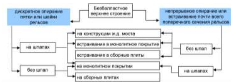
Рис. 1 Способы поддержки рельсов рельсовыми опорами в разных типах безбалластного верхнего строения пути [3]
