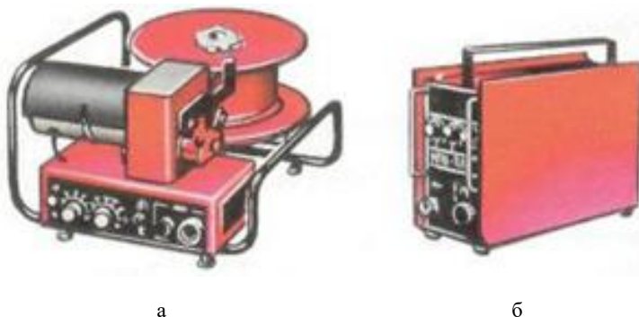
Рисунок 4.31 – Механизмы подачи проволоки а – открытого типа; б – закрытого типа
