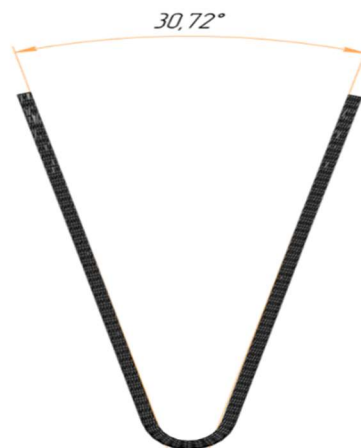
Рисунок 3 – Угол пружинения при использовании упругого элемента
