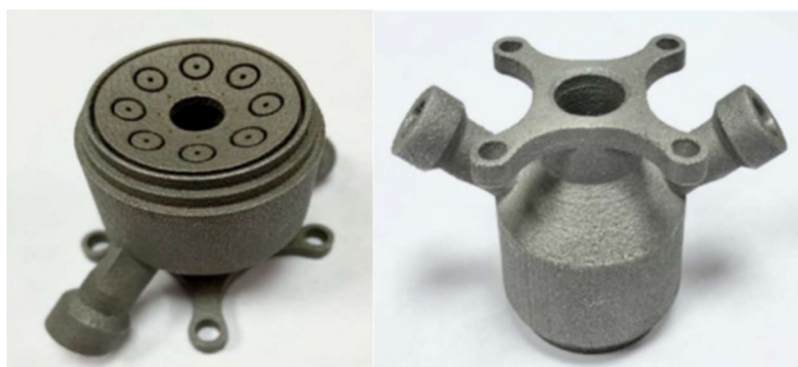
Рисунок 3 – Смесительная головка, изготовленная из Инконель 718
