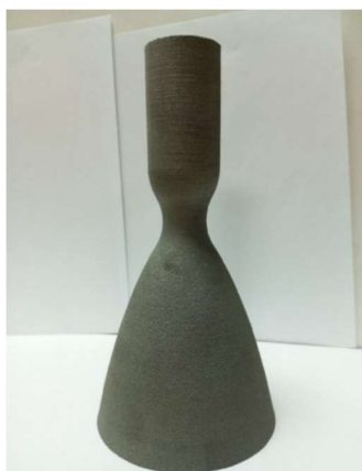
Рисунок 2 – Камера сгорания, изготовленная из Инконель 718
