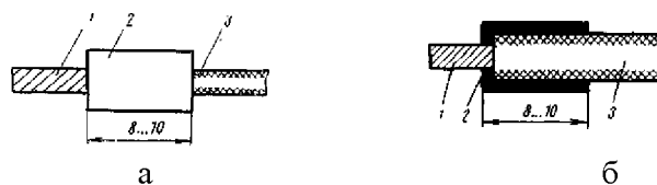
Рис. 2.1. Закрепление изоляции провода:
