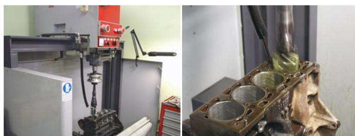
Рис. 143. Обработка постелей блока цилиндров на горизонтально-расточном станке (фирма «АБ - Инжиниринг», г. Москва).
