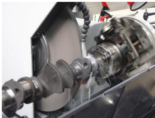
Рис.146 Шлифовка шеек коленчатого вала в фирме «Мотор - Технология» (г. Москва).
