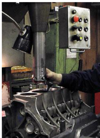
Рис. 142 Обработка цилиндров на вертикально-расточном станке (фирма «АБ - Инжиниринг», г. Москва)
