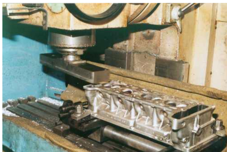
Рис. 149 Фрезерование плоскости головки блока (фирма "АБ - Инжиниринг", г. Москва)
