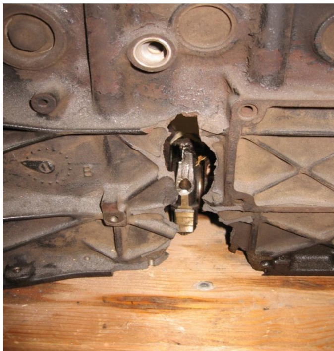
Рис. 104 Обрыв шатуна и его последствия для блока цилиндров
