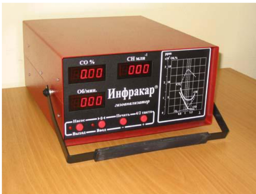
Рис. 121 Газоанализатор "Инфракар" модели 08, предназначенный для определения оксида углерода, суммы углеводородов в отработавших газах бензиновых автомобильных двигателей
