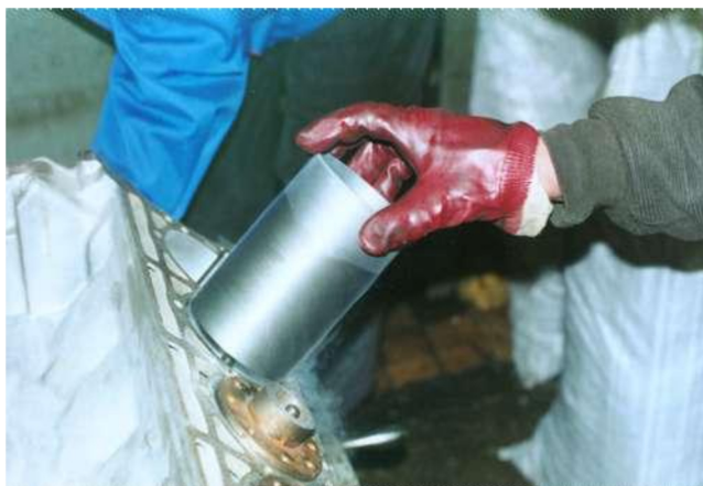
Рис. 141 Установка гильз в блок цилиндров после их охлаждения в жидком азоте
