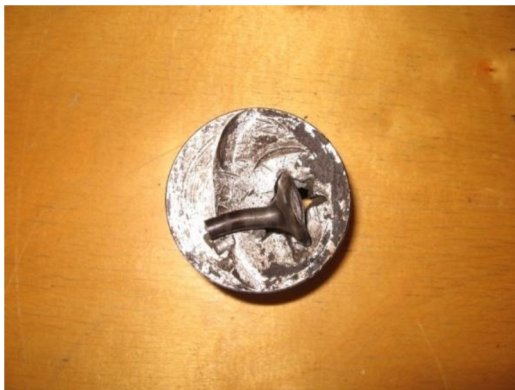
Рис. 31 Последствия обрыва ремня ГРМ (разрушение поршня и обрыв клапана)
