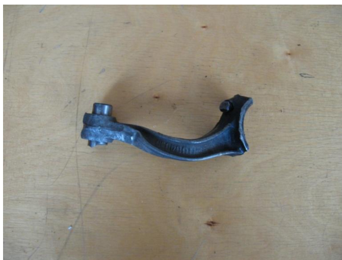
Рис. 105 Потеря устойчивости шатуном на такте сжатия
