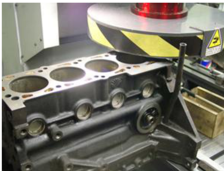
Рис. 148 Фрезерование плоскости блока цилиндров в фирме «Мотор - Технология» (г. Москва).
