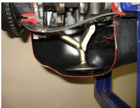
Рис. 43 Вид в разрезе на поддон двигателя с установленным в нем маслоприемником
