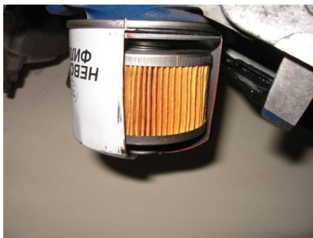
Рис. 46 Вид на фильтр, установленный на двигателе, в разрезе
