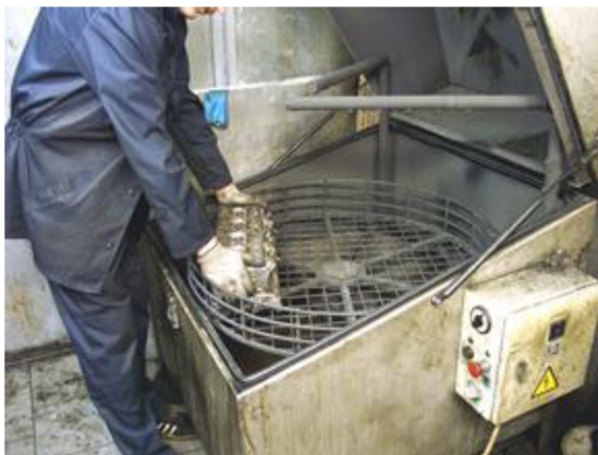
Рис. 140 Установка головки блока цилиндров в автоматическую моечную машину (фирма «Мотор-Технология», г. Москва). Мойка осуществляется моющим составом при 80°С
