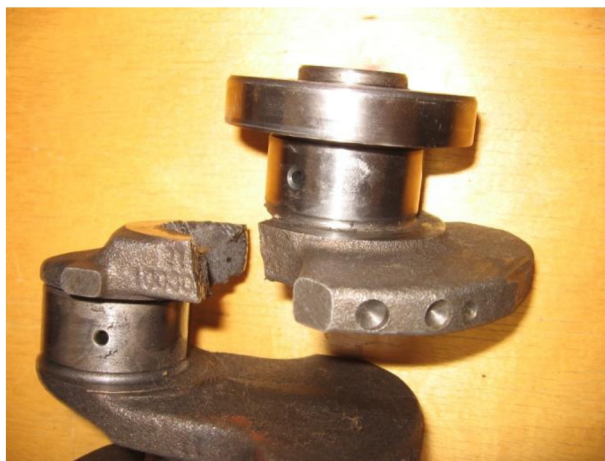
Рис. 108 Разрушение коленчатого вала форсированного двигателя при резком открытии дроссельной заслонки
