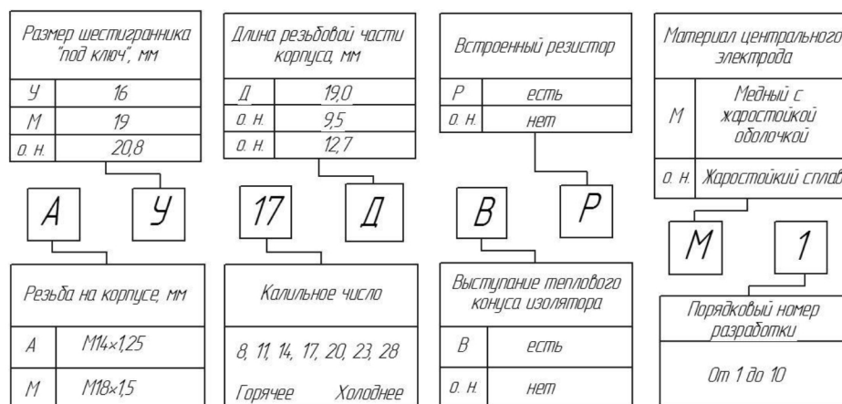
Рис. 79 Обозначение свечей зажигания по ОСТ 37.003.081
