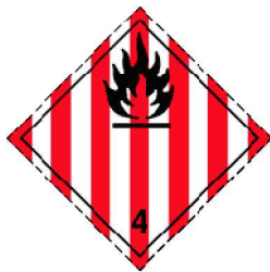
Рисунок 4.7. Знак опасности легковоспламеняющихся твёрдых веществ. Символ – пламя: цвет чёрный; фон белый с семью вертикальными красными полосами; цифра «4» – в нижнем углу
