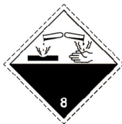
Рисунок 4.15. Знак опасности коррозионных веществ. Символ – жидкости, выливающиеся из двух пробирок и поражающие руку или металл: цвет чёрный; фон: верхняя половина – белая, нижняя – чёрная с белой каймой; цифра «8» белая – в нижнем углу
