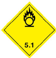
Рисунок 4.10. Знак опасности окисляющих веществ. Символ – пламя над окружностью: цвет чёрный; фон жёлтый; цифры «5.1» – в нижнем углу
