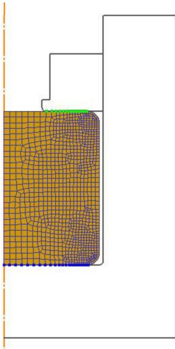
Рис. 13. Контактные поверхности между заготовкой, матрицей и контейнером
