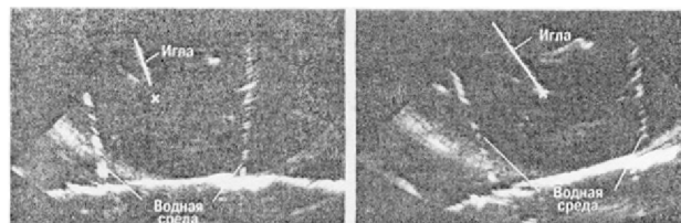
Рис. 27в. Изображение иглы в емкости с водой. Слева игла находится в плоскости сканирования не полностью, в результате чего выглядит короче, чем есть на самом деле (крестик определяет овальную глубину проникновения иглы). Справа игла визуализируется полностью.
