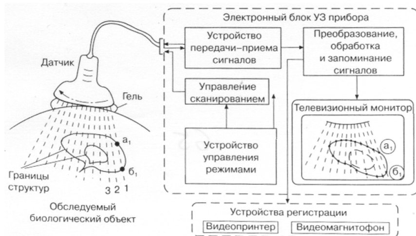
Рисунок 65. Структурная схема получения двухмерного изображения в УЗ приборе.
