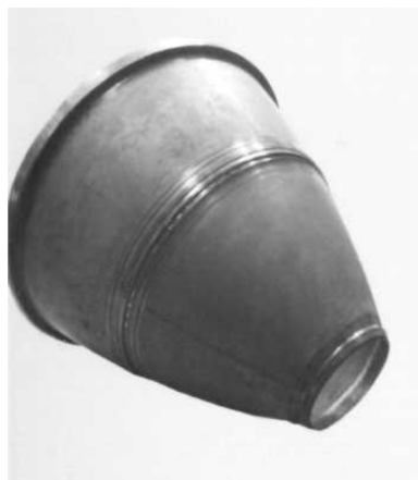
Рисунок 1.1 - Сопло, сплав ОТ4 (элемент камеры сгорания), габаритные размеры: диаметр 500 мм; толщина - 2.. .3 мм
