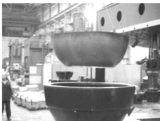
Рисунок 1.4 - Штамповка оболочки бытового отсека, алюминиевый сплав АД1, габаритные размеры: диаметр - 2500 мм; высота - 1500 мм; толщина - 2...3 мм
