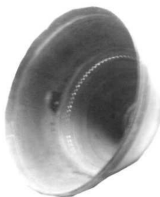
Рисунок 1.2 - Часть сопла, сплав ОТ4 (элемент камеры сгорания), габаритные размеры: диаметр 500 мм; толщина - 2.. .3 мм
