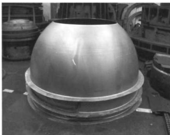
Рисунок 1.4 - Штамповка оболочки бытового отсека, алюминиевый сплав АД1, габаритные размеры: диаметр - 2500 мм; высота - 1500 мм; толщина - 2...3 мм
