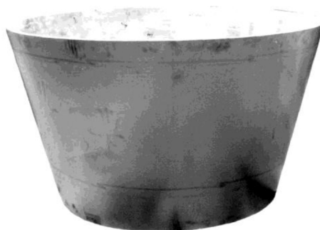
Рисунок 1.8 - Деталь из алюминиевого сплава, полученная ротационной вытяжкой
