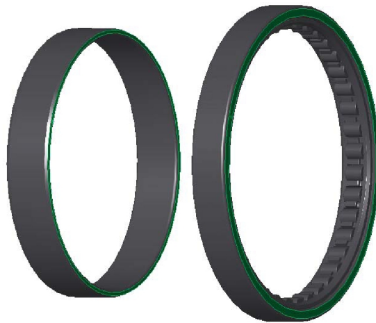
Рис. 52. Выделенные поверхности внутреннего и наружного колец подшипника
