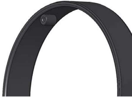
Рис. 59. Результат применения сопряжения Tangent (Касание)
