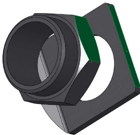
Рис. 56. Результат применения сопряжения Parallel (Параллельность)
