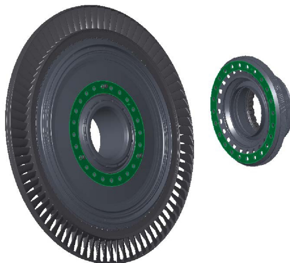
Рис. 48. Выделенные поверхности диска и вала
