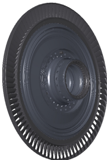
Рис. 49. Результат применения сопряжения Coincident (Совпадение)
