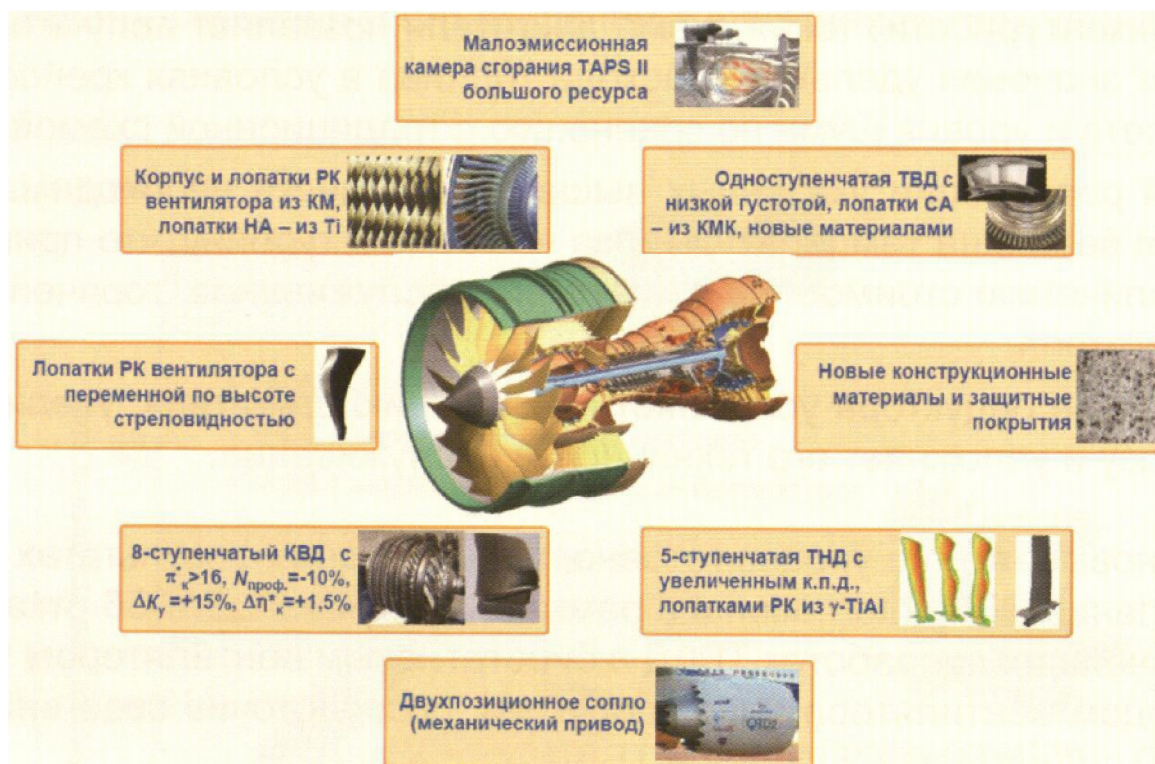
Рисунок 3.9 - Конструктивные особенности ТРДД LEAP-X
