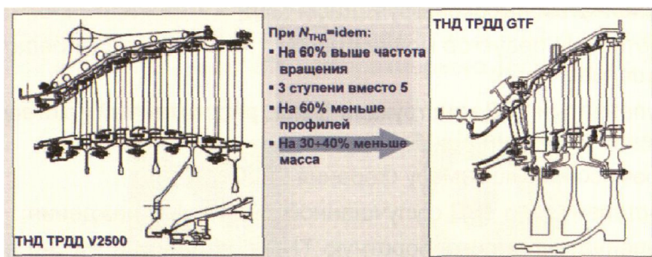
Рисунок 3.20 - Сравнение ТНД ТРДД V2500 и GTF
