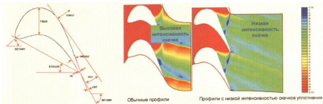
Рисунок 3.6 - Профиль лопаток РК ТВД с низкой интенсивностью скачков уплотнения на выходе и сравнение полей статического давления на выходе из турбины с разными профилями
