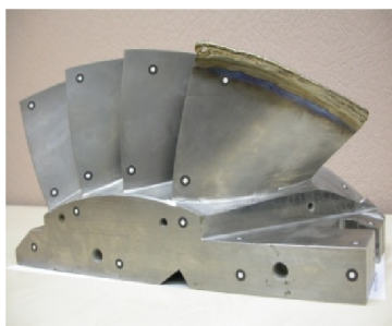
Рисунок 2.11 – Образец моноколеса после выполнения плакирования
