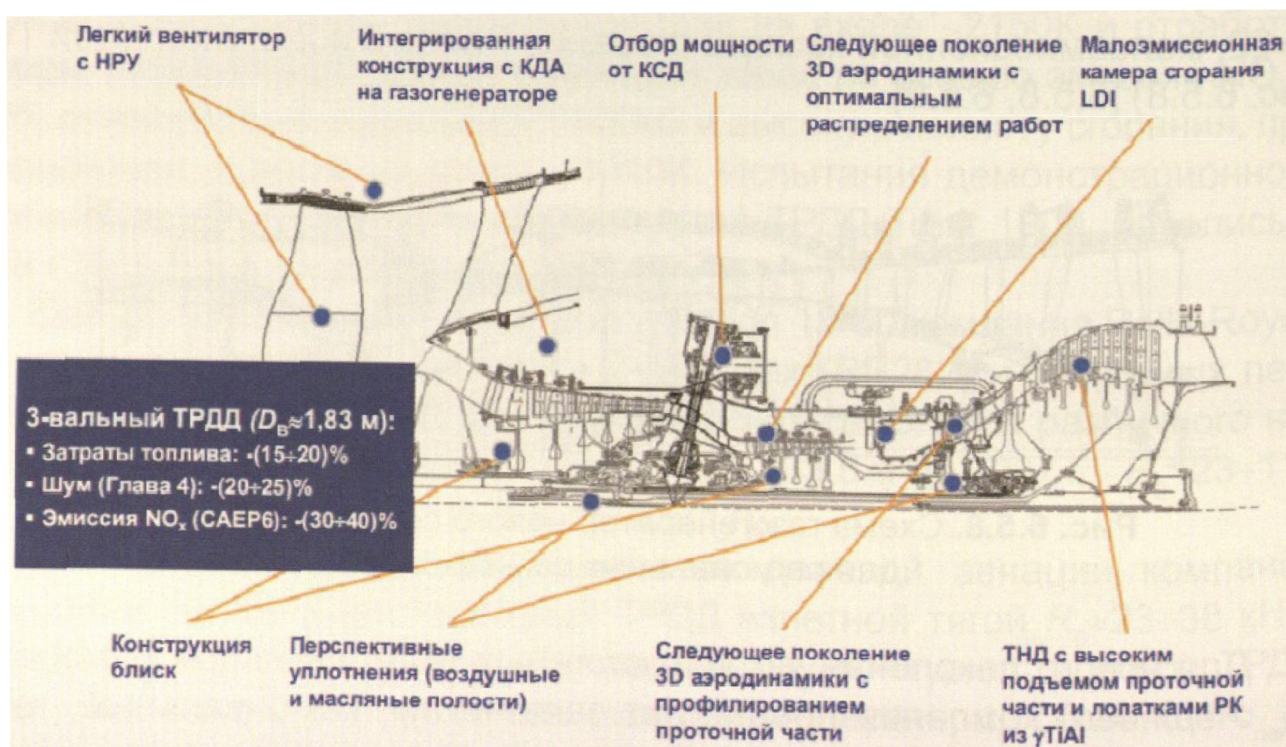
Рисунок 3.15 - Технологии 3-вального ТРДД RB285 компании Rolls-Royce
