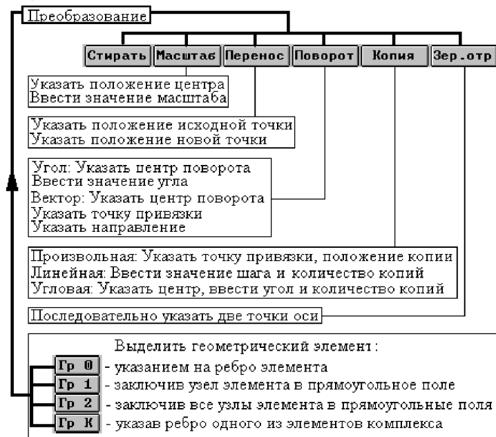
Рис.2.7 Алгоритмы аффинных преобразований на плоскости
