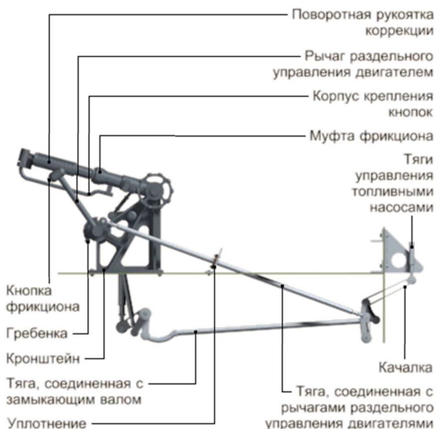
Рисунок 14 - Левая ручка ШАГ-ГАЗ
