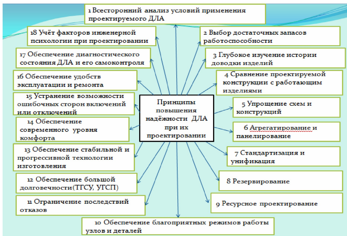
Рис. 57. Схема принципов повышения надёжности ДЛА при их проектировании
