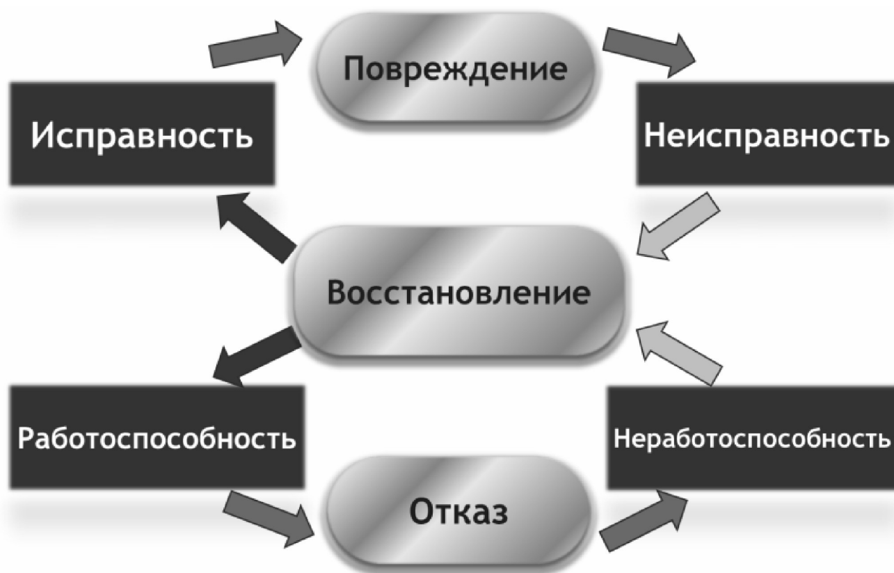
Рис. 14. Схема перехода изделия из одного состояния в другое
