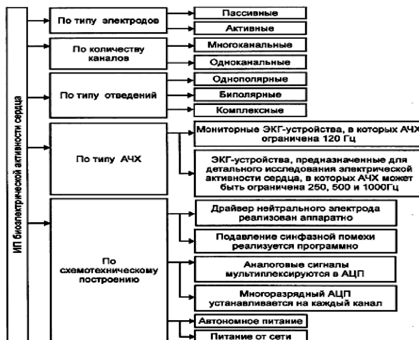
Рисунок 1.22 – Структурная схема классификации ИП биоэлектрической активности сердца
