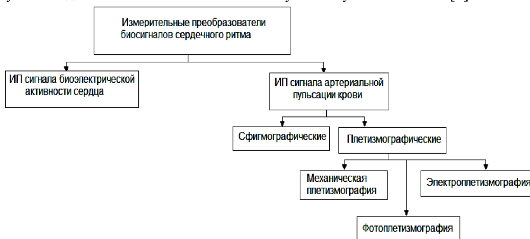
Рисунок 1.12 – Измерительные преобразователи биосигналов сердечного ритма
