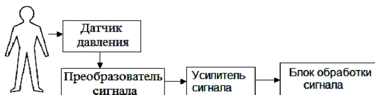
Рисунок 1.13 – Обобщенная структурная схема сфигмографического ИП артериальной пульсации крови
