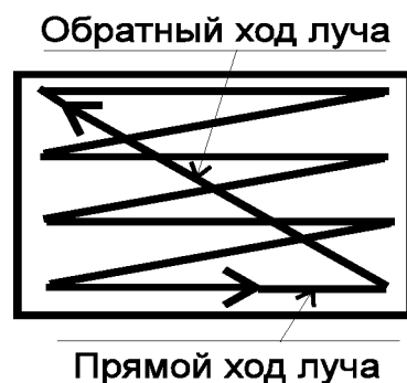
Рис. 1.33. Перемещение луча по экрану
