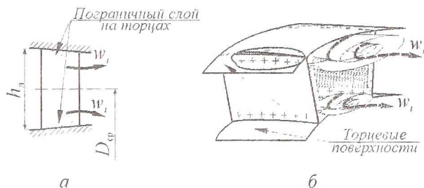
Р и с. 2.25. Схема образования концевых потерь: а - торцевые потери; б - образование парного вихря
