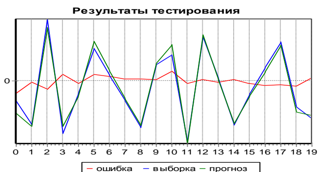
Рис. 6.12 Графики ошибки на этапе тестирования сети, тестирующей выборки и значения нейросети на этапе тестирования
