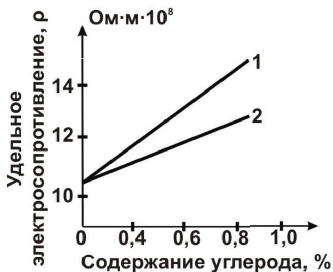
Рис. 1.4. График зависимости электросопротивления стали с пластинчатой (1) и зернистой (2) формами цементита от содержания углерода
