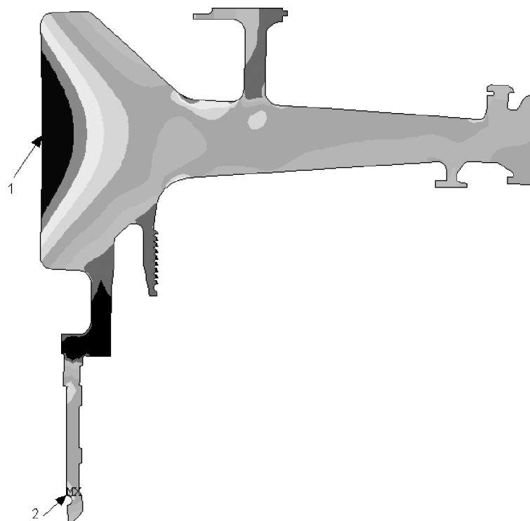
Рис. 4.6 Распределение напряжений по диску
