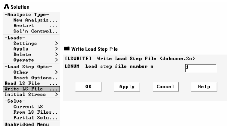
Рис. 4.14 Запись файла нагрузок в ANSYS
