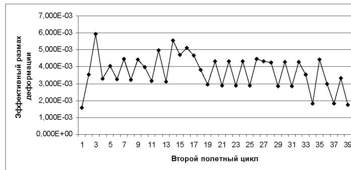
Рис. 4.20 Изменение полных деформаций по второму полетному циклу
