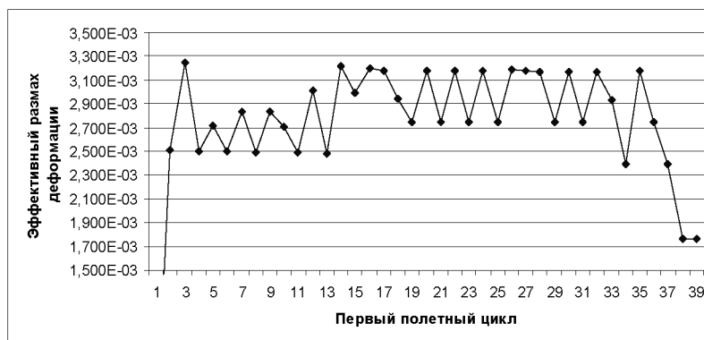
Рис. 4.18 Изменение полных деформаций по первому полетному циклу
