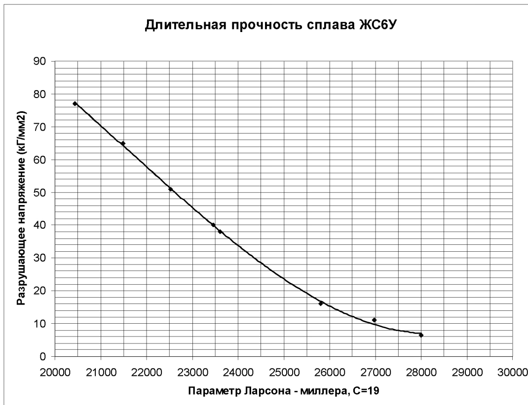
Рис. 4.11 Кривая длительной прочности материала ЖС6У
