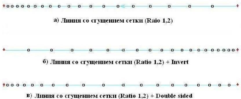
Рис. 3.12. Разные варианты сгущения сетки на линии
