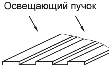
Рис. 10. Фрагмент бинарной фазовой дифракционной решетки
