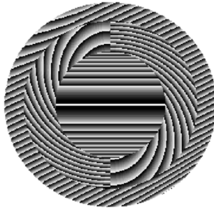
Рис. 34. Фотошаблон фокусатора в букву «R»
