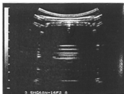
Рис. 63. Решетка на изображении нейлоновых линий в тканеэквивалентном фантоме, приводящая к штрихпунктирному изображению нитей.
