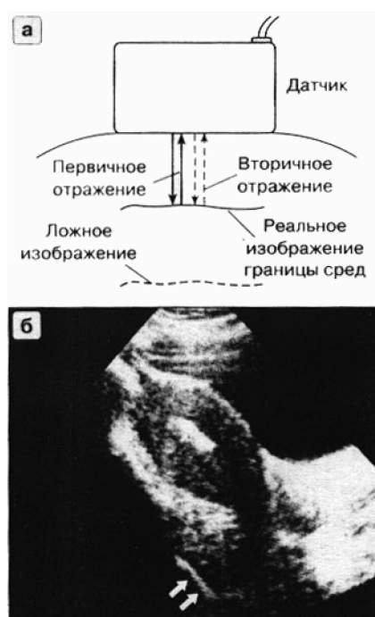
Рис. 67. Примеры реверберации, а – при наблюдении плоской границы сред. б - при наблюдении объема с высокой эхогенностью - внутриматочной спирали в полости матки (стрелками указано второе (ложное) изображение спирали).
