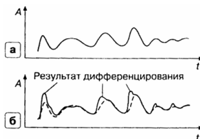
Рис. 46. Подчеркивание контуров с помощью дифференцирования эхо-сигналов. а - подчеркивание контуров отключено, б - подчеркивание контуров включено.
