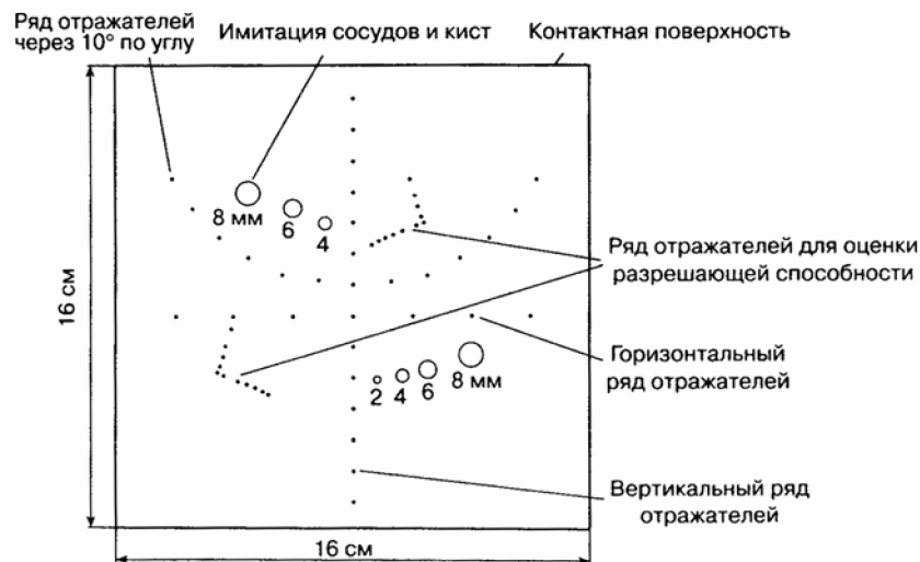
Рис. 51. Универсальный УЗ фантом для приборов с датчиками секторного сканирования: модель 515 ATS Labs.
