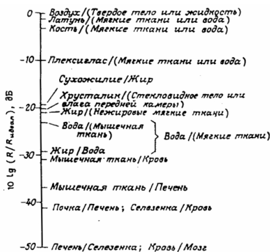
Рис. 12. Расчетные значения коэффициентов отражения (в децибелах по отношению к идеальному отражателю) при нормальном падении звуковых волн на границы раздела между различными биологическими и небιологическими средами.
