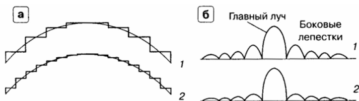
Рис. 40. Влияние числа каналов на точность формирования волнового фронта, а - волновой фронт, б - сечение УЗ луча
