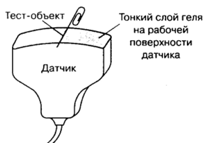
Рис. 48. Определение части элементов (или части апертуры) датчика, формирующих УЗ луч.
