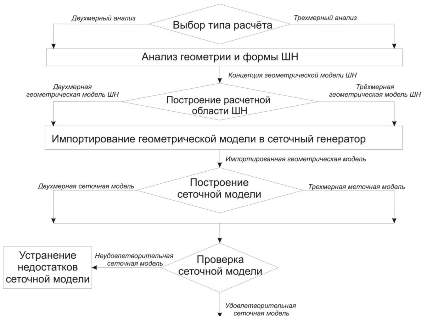
Рисунок 4.2 – Технологическая последовательность решения задачи моделирования рабочего процесса в шестеренном насосе
