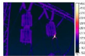
Нагрев контакта ВЧ заградителя (снимок сделан тепловизором ТН-7102)
