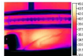
Внутренний нагрев в нижней части бака реактора (снимок сделан тепловизором ТН-5104)
