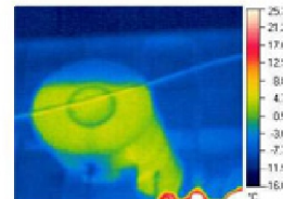
Контроль уровня масла по тепловой картине (снимок сделан тепловизором ТН-5104)
