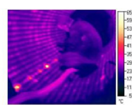
Контроль качества статора генератора (снимок сделан тепловизором ТН-5104)
