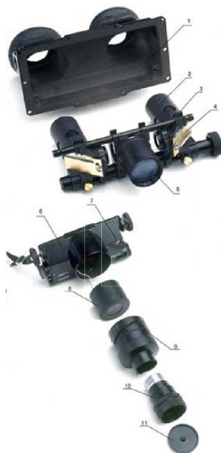
Рис. 14. Устройство ОНВ псевдобинокулярной схемы (на примере ПНВ74): 1 - корпус ОНВ, 2 – окуляр, 3 - оборачивающий объектив, 4 - зеркало, 5 - коллиматор (лупа) с призмой, 6 - корпус ОНВ, 7 - ИК-подсветка, 8 – ЭОП, 9 - корпус объектива, 10 – объектив, 11 - крышка объектива
