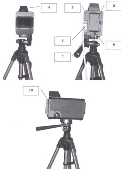
Рис. 27. Основные элементы тепловизора
